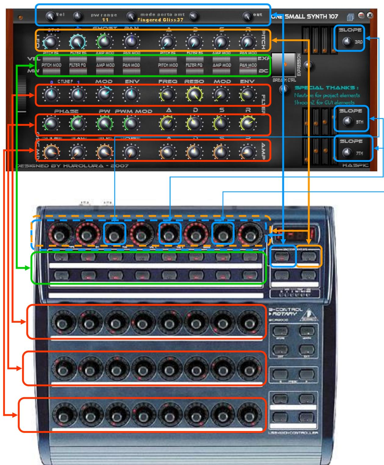
Comme la surface de contrôle sur le PC est organisée de manière similaire à celle d'une surface de contrôle MIDI comme le BCR 2000, la plupart des éléments de contrôle sont positionnés à la même place sur les 2 surfaces de contrôle. La surface de contrôle présente sous Scope peut alors servir d'outil de visualisation amélioré pour ajuster un son depuis la surface de contrôle MIDI sans avoir besoin d'utiliser la souris en dehors des opérations de sauvegarde de presets.
