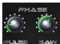
Ces contrôles permettent d'ajuster les phases relatives des oscillateurs rectangulaires et dent de scie.
